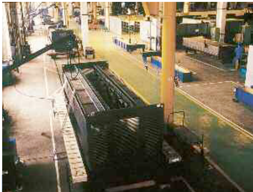
Montage von Absorptionskältemaschinen im Werk in China
